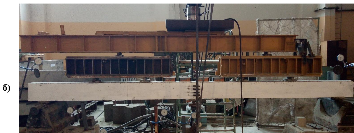
1 – гидравлический домкрат; 2 – распределительная траверса; 3 – прогибомер БПАО; 4 – образцовый динамометр ДОР-50; 5 – датчики деформаций системы «Терем-4»; 6 – электронный инклинометр.
