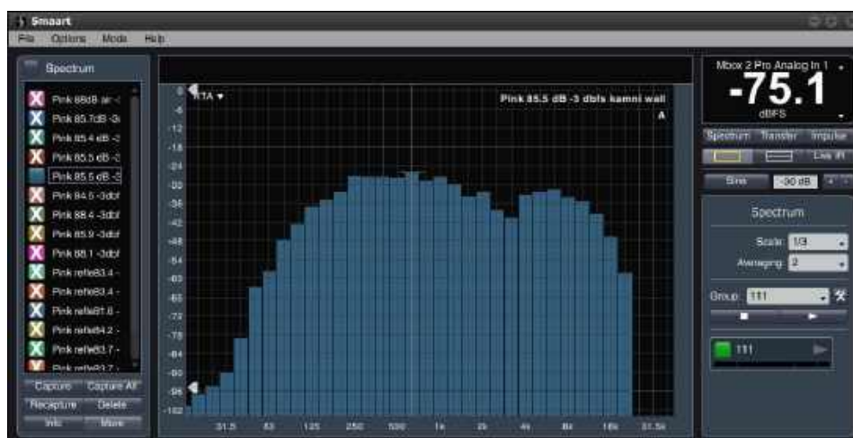
Рисунок 9 – Спектр отраженного звука от рифленой поверхности образца
