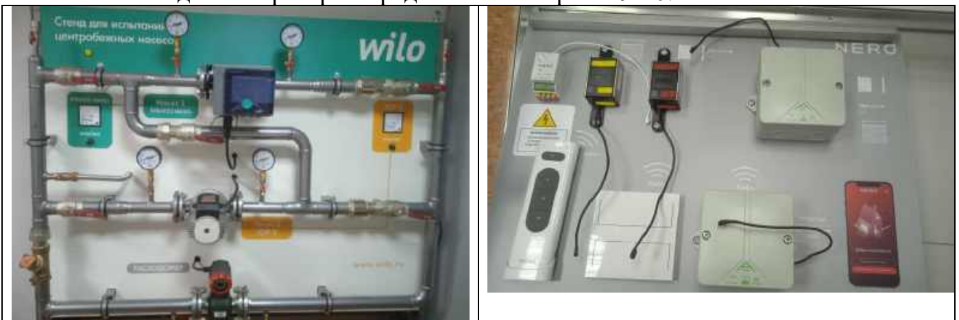
Рисунок 19 – Стенды «Исследование современного насосного оборудования» и «Элементы автоматизации «Умного дома»
