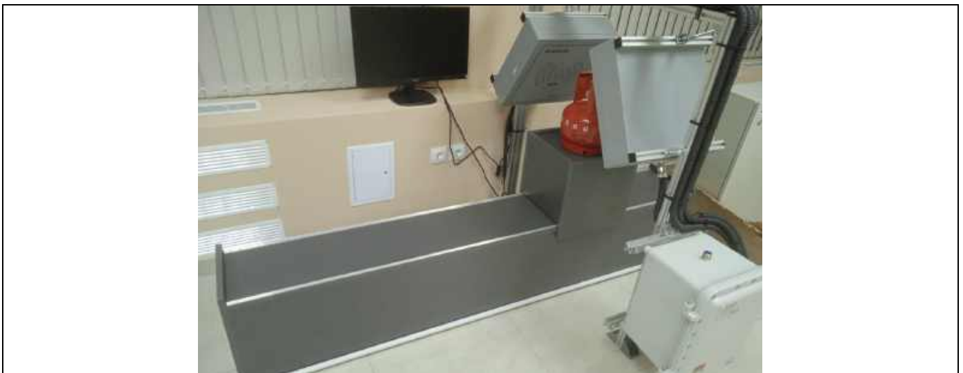
Рисунок 4 – Макет конвейерной ленты с баллоном и считывателями RFID-MeT0k
