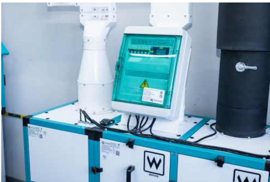
Рисунок 15 – Элементы станда установка приточно-вытяжная
