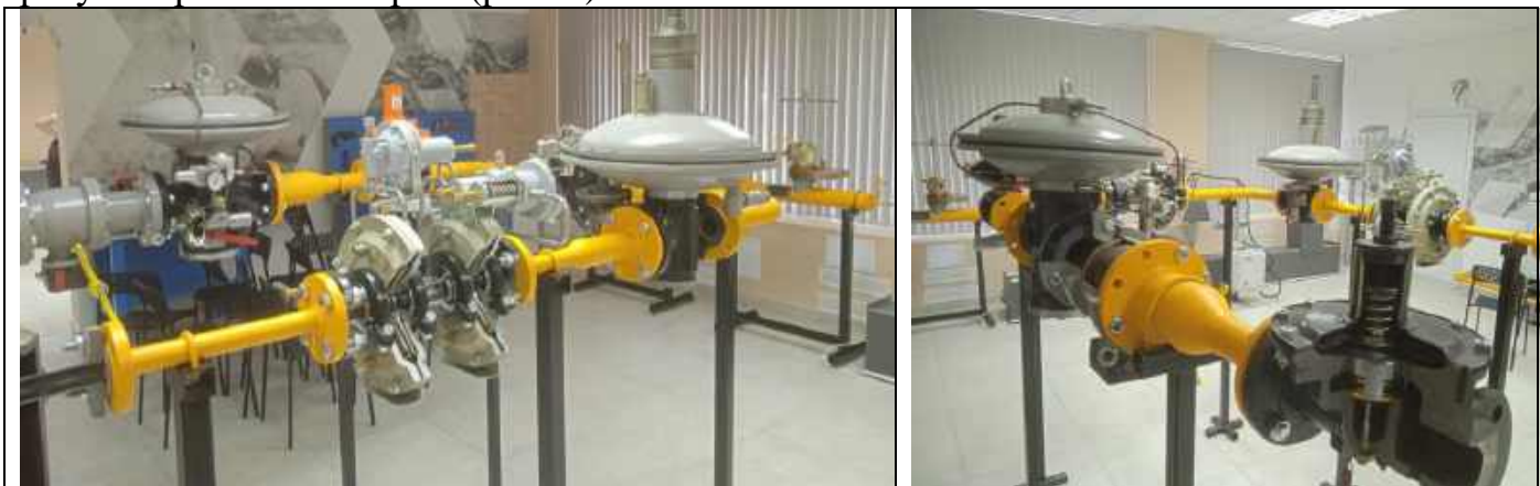
Рисунок 1 –Стенд для изучения конструкции оборудования
