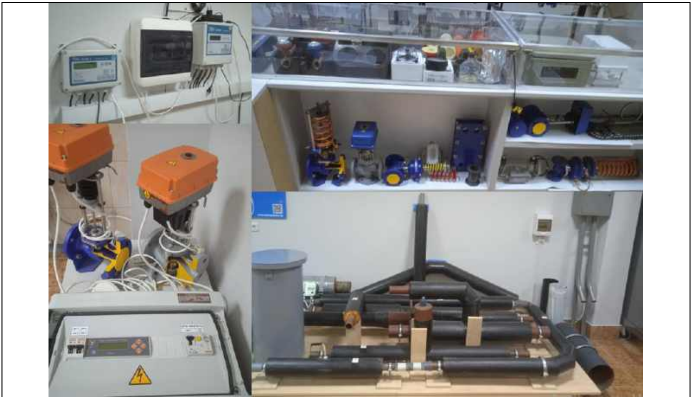
Рисунок 20 – Стенды для исследования автоматических регуляторов и оборудования систем теплоснабжения, а также для изучения работы системы оперативного дистанционного контроля за состоянием теплоизоляции тепловой сети
